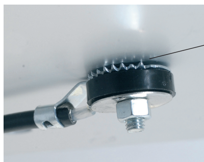
Befestigung Unterseite Metallplatte
